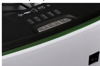
Kontrolky zapnutí, plného koše a zaseknutého papíru
